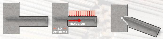
Aplicando el concepto de Longitud de desarrollo (Ld), el acero de refuerzo trabaja hasta su máxima resistencia evitando el desprendimiento del concreto de la ménsula. Si se presenta una deficiencia en la longitud de empotramiento frente al valor calculado de Ld, se pronostica una falla frágil del concreto de la ménsula con una carga menor a la de diseño. Por el contrario, en caso de un sobre esfuerzo inducido a la barra que tiene una longitud adecuada Ld, se evitará una falla catastrófica.
