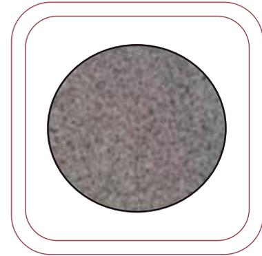
Estructura homogénea de una barra corrugada PazdelRío
