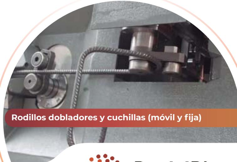
Rodillos dobladores y cuchillas (móvil y fija)
